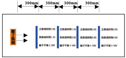
測試條件:大風量(≈4.6 m³/min)22±2℃45±5%RH
